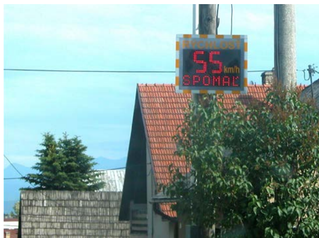
Fot. 23. Świetlny znak pokazuje prędkość, z jaką się jedzie. Wyświetla prędkość tylko wtedy, gdy się przekracza tę dozwoloną – Słowacja
