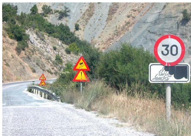
Fot. 8. Znak „ograniczenie prędkości” z tabliczką mówiącą, że ograniczenie jest powiązane z mokrą nawierzchnią – Grecja
