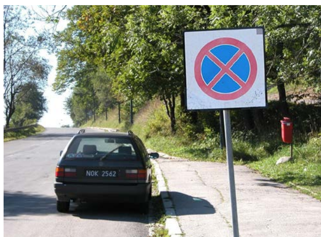
Fot. 1. Znak „zakaz zatrzymywania się” (B-36) na kwadratowym tle, nawiązujący wyglądem bezpośrednio do znaku strefowego – Polska
