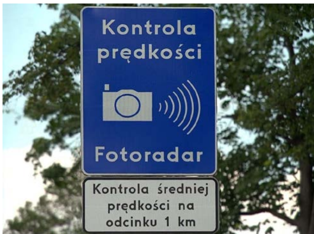
Fot. 20. Znak „kontrola prędkości” z nieczytelną tabliczką mówiącą, że kontrola jest przeprowadzana na odcinku 1 km – Polska
