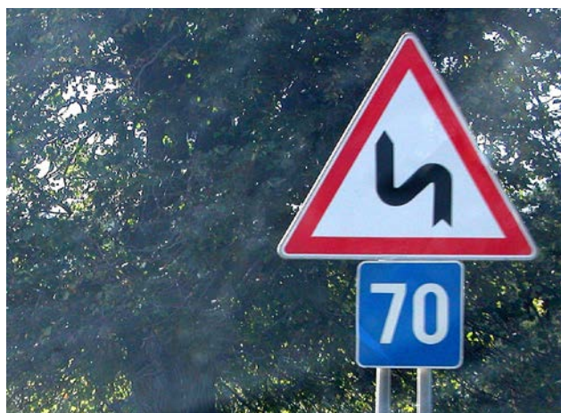
Fot. 12. Znak „niebezpieczne zakręty – pierwszy w lewo” z „prędkością zalecaną” 70 km/h – Słowacja
