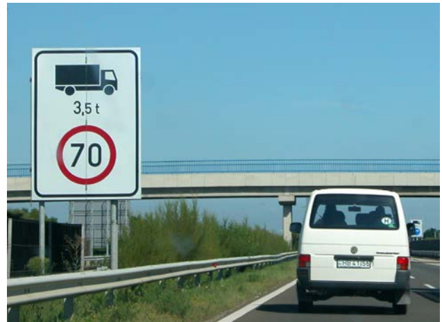
Fot. 11. Znak tablicowy „ograniczenie prędkości” dla samochodów ciężarowych o masie powyżej 3,5 t, w konwencji znaku strefowego – Węgry
