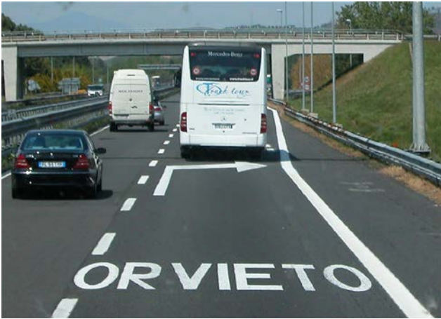
Fot. 3. Oznakowanie poziome na autostradzie, w którym oprócz strzałki kierunkowej figuruje nazwa miejscowości (Włochy)
