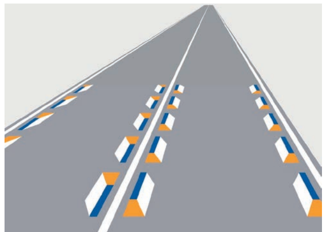
Rys. 6. Oznakowanie 3D typu „blok” wykazujące znaczne zniekształcenia przy naniesieniu na obydwu, przeciwnych pasach ruchu
