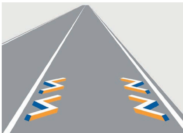
Rys. 2. Oznakowanie 3D typu „piorun” ( thunder type ) odtworzone na bazie prac japońskiej korporacji Sekisui Jushi z połowy lat 90. ub. w.
