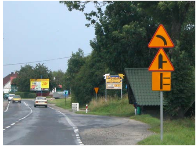
Fot. 15. Znak zapowiadający niebezpieczny zakręt w lewo (A-2) oraz skrzyżowanie z drogą podporządkowaną (A-6b) z tabliczką wskazującą układ dróg podporządkowanych (T-6b)
