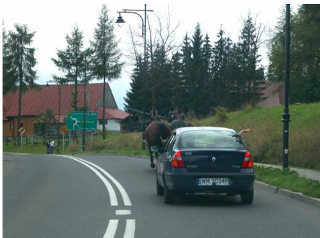
Fot. 12. Podwójna linia ciągła zabraniająca przejeżdżania przez tę linię i najeżdżania na nią, co na widocznym odcinku zabrania wyprzedzenia powoli poruszającego się zaprzęgu konnego
