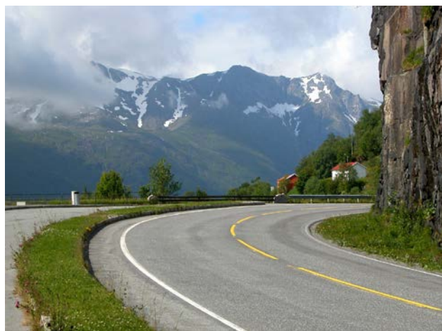
Fot. 13. Linia ostrzegawcza – przerywana o długich odcinkach i krótkich przerwach. Jej znaczenie: „przekraczanie tej linii ryzykowne, zalecane jest nie wyprzedzać” (Norwegia)
