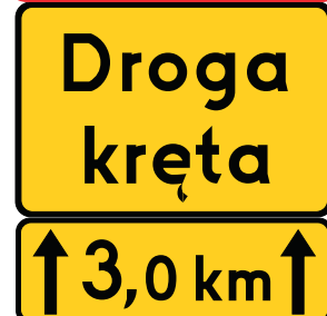
Rys. 11. Znak „niebezpieczne zakręty – pierwszy w prawo” z tabliczką oznaczającą drogę krętą (werbalnie) oraz z tabliczką podającą dystans obowiązywania
