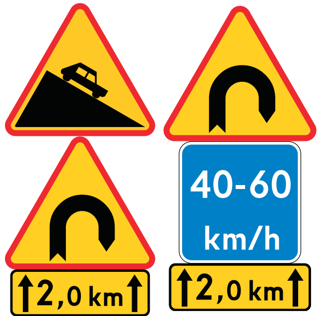
Rys. 18. Propozycje zestawów znaków dla sytuacji, w których na niebezpieczne zjazdy nakładają się rejon niebezpiecznych serpentyn i gdzie można by zastosować bardziej zwięzłe i czytelne oznakowanie
