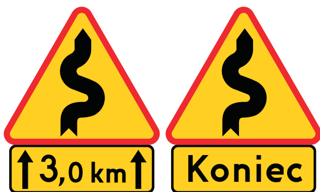
Rys. 14. Para znaków „droga kręta – pierwszy zakręt w prawo”; jeden z tabliczką wskazującą długość odcinka, na którym występują zakręty (T-2), a drugi z tabliczką na końcu tego odcinka (T-3)
