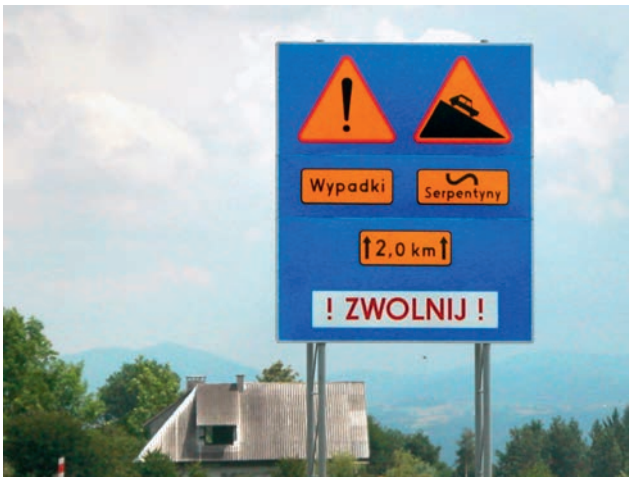
Fot. 1. Niekonwencjonalna tablica informująca o niebezpiecznych zakrętach – serpentynach, ostrzegająca o niebezpiecznym zjeździe i o rejonie wypadków na dystansie 2 km; połączona z hasłem „zwolnij”
