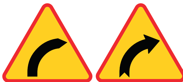
Rys. 3. Znak „niebezpieczny zakręt w prawo” z uciętym prostopadle wizerunkiem drogi na wjeździe
