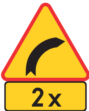
Rys. 10. Znak „zakręt w prawo wymagający ostrożności z nową tabliczką informującą o następstwie dwóch zakrętów w prawo.
