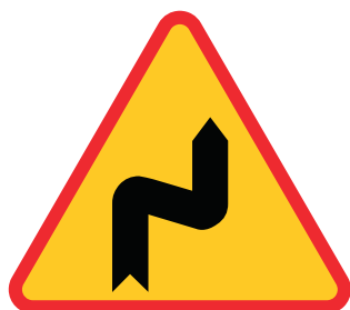
Rys. 7. Znak „niebezpieczne zakręty – pierwszy w prawo, drugi w lewo” (wymagające zwolnienia).
