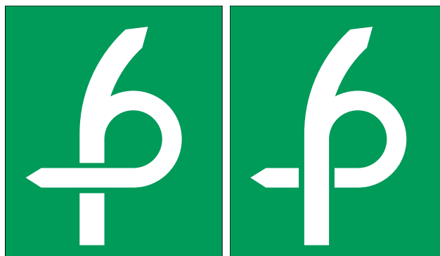
Rys. 20. Projekt adekwatnego odwzorowania zakrętu w rejonie węzła, co z jednej strony ukazuje pełny kształt skrętu, a z drugiej wskazuje ostateczny kierunek, w jakim droga od węzła zmierza
