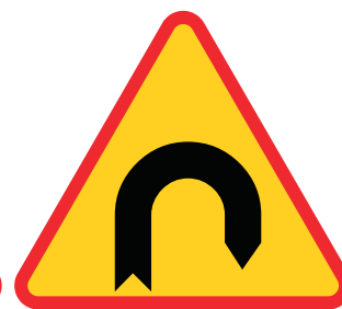
Rys. 6. Znak „niebezpieczny zakręt w prawo typu serpentyna”, zwrot o 135°-180° (- 220°)
