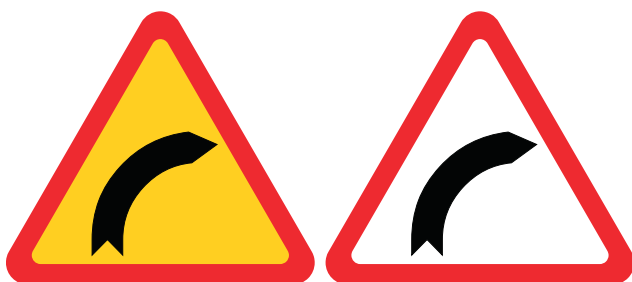
Rys. 2. Znak „niebezpieczny zakręt w prawo” w kolorystyce obowiązującej i w kolorystyce białoczerwonej z pogrubioną obwódką, lepiej „odcinającą od tła”, z nieco zmniejszonym piktogramem
