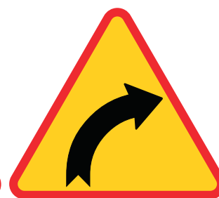
Rys. 4. Znak „niebezpieczny zakręt w prawo” z grotem strzałki na wjeździe większym niż obręb drogi.
