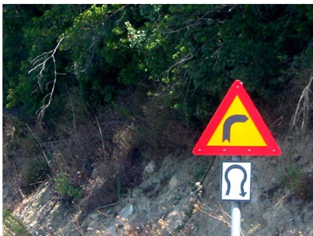
Fot. 9. Znak „niebezpieczny zakręt w prawo” z tabliczką wynikającą z rozporządzenia o znakach, uprzedzającej o zakręcie o zwrocie drogi o 180° (Grecja)
