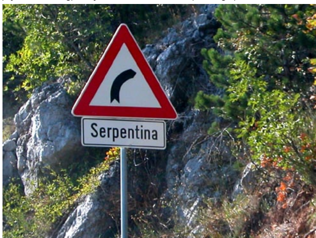
Fot. 8. Znak „niebezpieczny zakręt w prawo” z napisem „Serpentina” na tabliczce uprzedzającej o zakręcie o zwrocie drogi rzędu 180° (Chorwacja)
