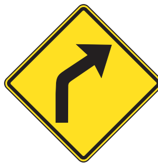
Rys. 15. Znak z 1942 roku dla łuku poziomego w prawo, z wyraźniejszym rysunkiem strzałki
