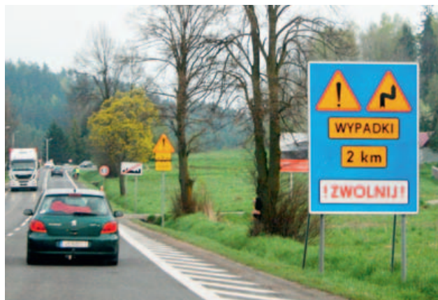
Fot. 13. Niekonwencjonalna tablica zastępuje znaki „inne niebezpieczeństwo” (A-30) i „niebezpieczne zakręty...” (A-3) ze wskazanym dystansu 2 km z dodatkowymi napisami: „WYPADKI” oraz „!ZWOLNIJ!”
