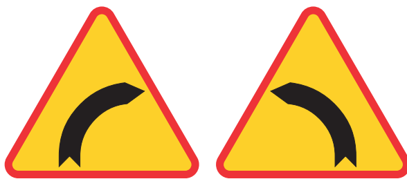
Rys. 1. Znaki „niebezpieczny zakręt” (A-1 i A-2)
