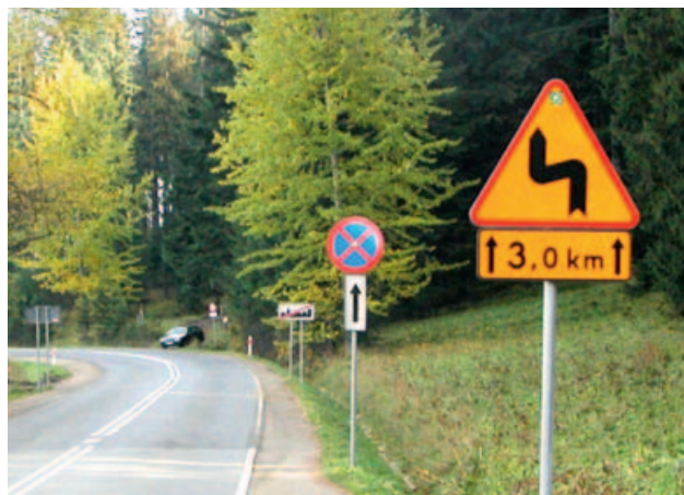
Fot. 2. Znak „niebezpieczne zakręty – pierwszy w lewo” (A-3) z tabliczką wskazującą dystans występowania zakrętów (T-2)
