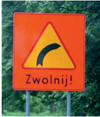
Fot. 10. Tablica z jaskrawym tłem jako znak niekonwencjonalny z zastosowaniem symbolu „niebezpieczny zakręt w prawo” (A-1) i dodatkowym napisem „Zwolnij!”
