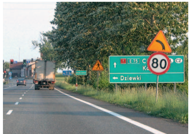
Fot. 8. Znak „niebezpieczny zakręt w lewo” (A-2) występujący razem z ograniczeniem prędkości (B-33) dotyczącym skrzyżowania
